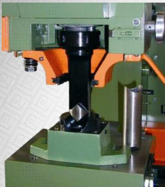
Utensili per scantonare i tubi per giunti a 90°. Fino a 60 mm di diametro del tubo
