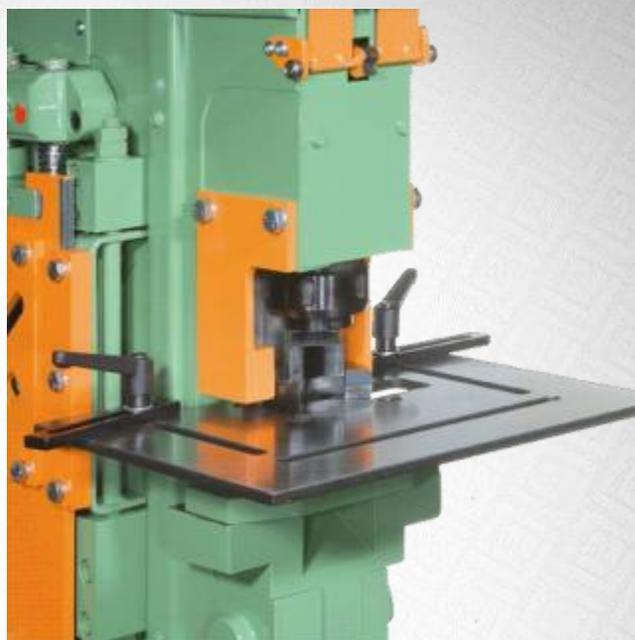
Solo per Peddicat No. 1 Dispositivo di punzonatura per stazione di scantonatura
