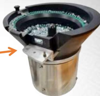
Questo sistema è costituito da un contenitore di inserti predisposto per alimentare automaticamente gli inserti attraverso un modulo di orientamento e un altro di individualizzazione.
