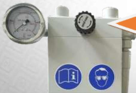
La preparazione dell'inserto inizia con la regolazione della pressione della valvola, che viene eseguita a seconda dell'inserto.
