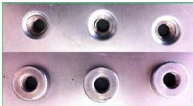
Rivettatura con utensile regolabile.
