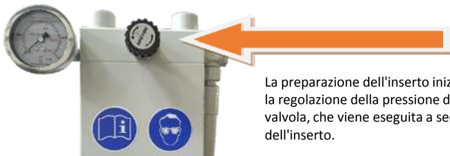
La preparazione dell'inserto inizia con la regolazione della pressione della valvola, che viene eseguita a seconda dell'inserto.
