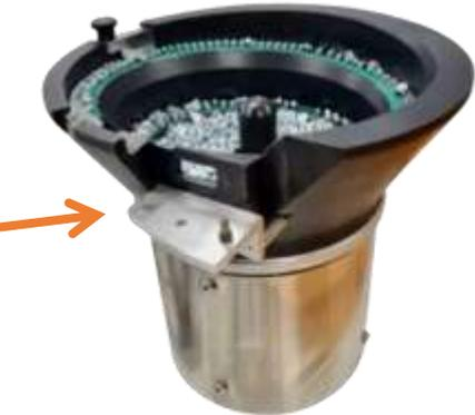
Questo sistema è costituito da un contenitore di inserti predisposto per alimentare automaticamente gli inserti attraverso un modulo di orientamento e un altro di individualizzazione.
